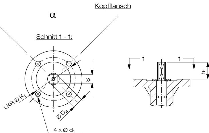
Kopfflanschmaße in [mm] für Befestigung und Antriebsaufbau (DIN EN ISO 5211)
